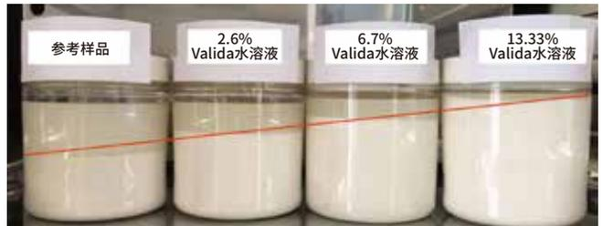
图4 ❖ 抗流挂性能。左：参考配方样品；右：基于Valida的涂料。以ASTM D4400方法为内部测试
