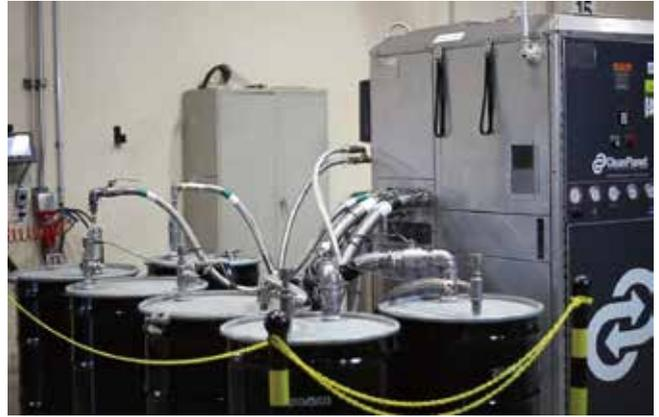
闭环回收可延长溶剂的使用寿命,并将排放量降至最低。照片由Ship & Shore Environmental提供。
