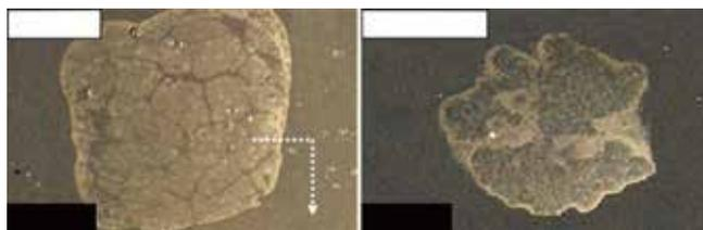
本文是旨在研究由各种生物物质引起的涂层降解的综合工作的一部分。由数码相机记录下来, 关于暴露于鸟粪和胰酶(合成当量)的汽车透明涂层上观察到的典型缺陷如图1所示。<sup>11</sup>
