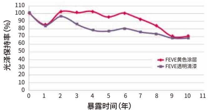
条红色的轻密封胶带覆盖。该区域被认为是未暴露区域。测试结果表明，15年后，基于FEVE体系的防护涂层样板表现出显著的防腐蚀和防老化效果（图6）。
