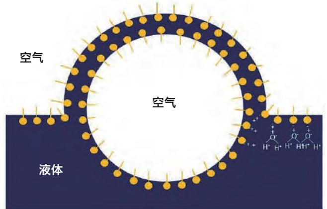
图4 ❖ 液膜的破裂阶段。
