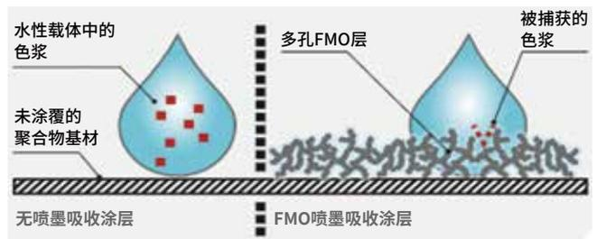
图2 ❖ 由CAB-O-SPERSE 4012K-F分散体和聚合物粘合剂组成的喷墨吸收涂层示意图。
