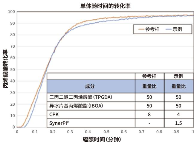
固化深度, 并促进聚合动力学的改善, 因此在我们的模型系统中, 光引发剂的浓度可以减少多达50%, 而性能没有明显差异。此外, 这些优点已在诺里什I型和II型系统中得到了证明。
