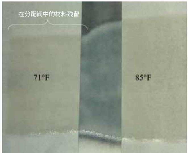
型显示了涂料在流经输送系统到应用点时的温度变化 (见第1部分, 图4)。这种变化是非常显著的, 我们经常会谈及涂料的温度在加热器和应用点之间是否真的发生了显著变化。在那一部分, 我们还介绍了两个在线加热器应用的好的示例 (第1部分, 图5和6)。更深入地研究这些应用, 真的可以让我们明白这一点。
