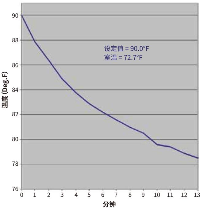
这可以从图7中完全预见。当喷枪中较冷 (71°F) 的材料被分配时, 图案更窄、更重, 但当较热的材料 (85°F) 到达喷枪时, 较低的粘度导致图案变宽, 覆盖变薄。这可能很容易使输送链中任何位置的配件, 产生一个非粘性材料的小段, 并导致可能被发现或可能不会被发现的缺陷。
