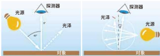
图5 ❖ 光在平面上的漫反射和镜面反射。
