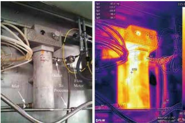
图 11 ❖ 喷漆室内2K体系的热扫描图。<sup>4</sup>
