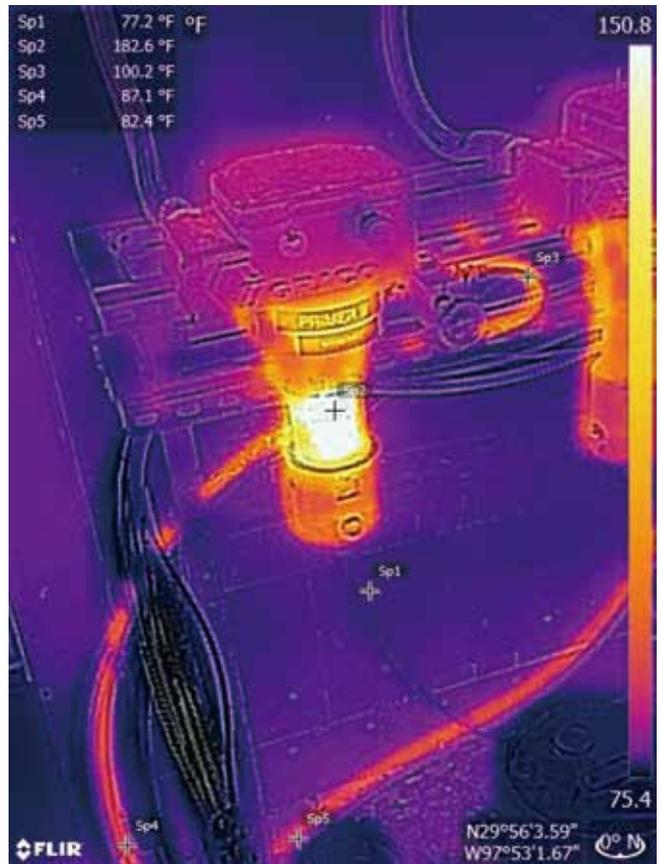
同样，我们看到涂料组分在软管中移动时温度也下降了，其中B组分为93°F (Sp4)，A组分为85°F (Sp8)，它们与每个加热器的距离大致相等。正如我们在图12中所看到的那样，这种温度下降沿着通往喷漆室环境的路径继续进行，B组分到了87°F (Sp4)，A组分为82.5°F (Sp5)。它们越来越接近环境温度，因为每个组分与环境温差的不同损耗率，它们之间的差异正在缩小。与前面的例子一样，涂层组分到达机器人时非常接近周围环境——这就好像路径中根本没有加热器一样。
