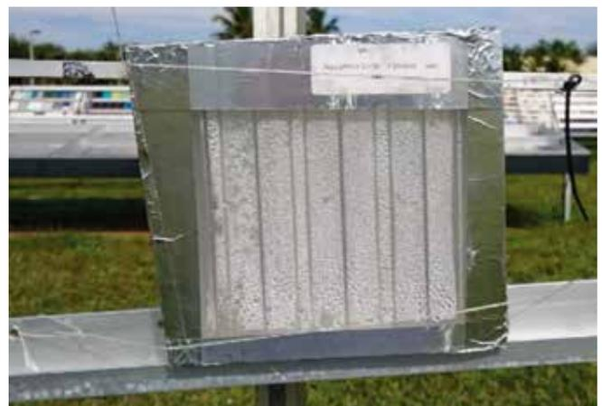
**表 6** ❖ 佛罗里达户外暴露1年后，汽车前照灯上1K PUD PC透明涂层的实验结果。
